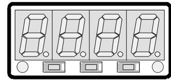
Der Zustand der Relais wird mit Hilfe der linken LED unterhalb der 7-Segmentanzeige angezeigt.
