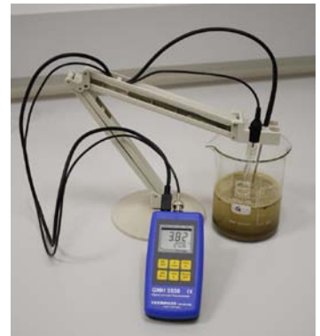
GMH 3530 + Elektrodenhalter GEH 1
