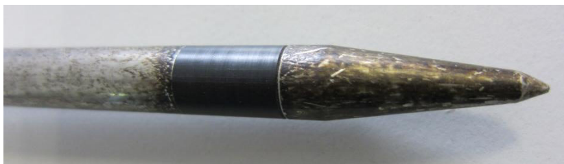
Verunreinigte Elektrodenspitze -> misst falsch!
