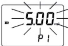
**Über dem Messbereich:** ein blinkender Wert der maximalen Konzentration zeigt an, dass der Messbereich überschritten wurde. Die Probenkonzentration liegt über dem programmierten Bereich: verdünnen Sie die Probe und führen Sie die Messung erneut durch.
