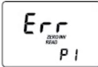
**Vertauschte Küvetten:** Proben- und Blindprobenküvette sind vertauscht.
