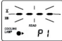
**Cooling lamp:** Das Gerät wartet, dass die Lampe abkühlt.
