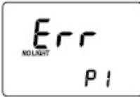
**No Light Low (Kein Licht):** das Gerät kann die Lichtmenge nicht anpassen. Bitte überprüfen Sie, dass die Proben keine Fremdkörper enthalten.
