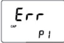
**Cap error:** diese Meldung erscheint, wenn externes Licht in die Messzelle dringt. Stellen Sie sicher, dass ein Kuvettendeckel vorhanden ist.
