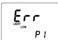
**Light Low (Zu wenig Licht):** es ist nicht genügend Licht für eine Messung vorhanden. Bitte überprüfen Sie die Blindprobenküvette.
