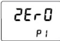
**Zero:** Ein Nullabgleich wurde nicht durchgeführt und muss zuerst durchgeführt werden. Befolgen Sie hierzu die entsprechenden Hinweise.
