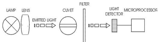
Die gemessene Extinktion  $E$  ist zur Konzentration des Wasserinhaltsstoffes direkt proportional. Die Extinktion hängt bei gegebenem Extinktionskoeffizient und konstanter Schichtdicke der Küvette ausschließlich von der Konzentration ab.
