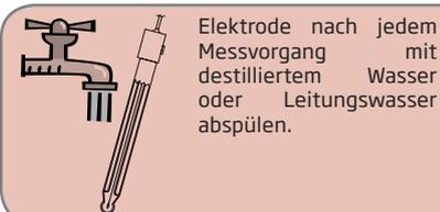
Elektrode nach jedem Messvorgang mit destilliertem Wasser oder Leitungswasser abspülen.
