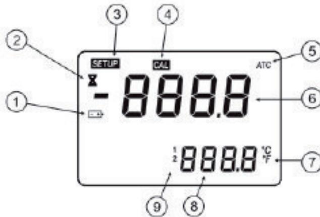
1. Batterie (blinkt bei schwacher Batterieladung)
