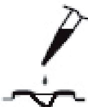
3. Drücken Sie die Read Taste. Der Messwert wird in der gesetzten Einheit (Volumengehalt in % oder Gefrierpunkt) angezeigt.
