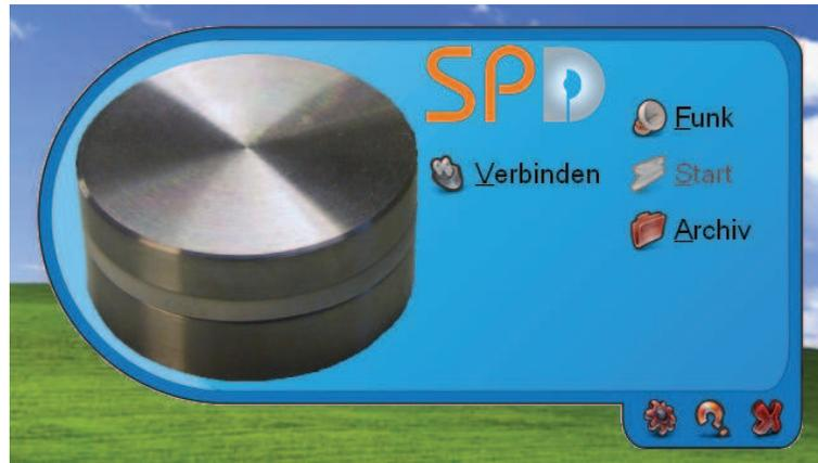
Der zentrale Abschnitt des Hauptfensters beinhaltet die Funktionsschalter. Am unteren Rand befinden sich die Schalter: Konfiguration, Programminformationen anzeigen und Programm schließen. Sollten Sie das Fenster auf der Windows-Oberfläche verschieben wollen, linksklicken Sie auf den dunkelblauen Rahmen am oberen Fensterrand und halten Sie die Maustaste gedrückt und bewegen Sie das Fenster an die gewünschte Position.
